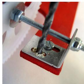
zweite Bohrung durch Alu
